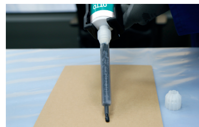
Uittreden rups en homogeniteit van het mengsel controleren (zie verwerking begeleidende kwaliteitscontroles 2K-producten)
