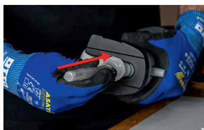
Materiaal afvegen en OTTO statische menger ACF ORBIS 12-24X 10:1 opzetten
