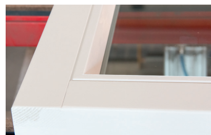
Afdichten van isolatieglas
