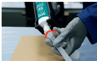
Materiaal afvegen en OTTO statische menger MGQ 10-16D er tot de aanslag op schroeven
