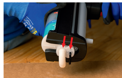
Materiaal zonder statische menger uitdrukken, tot bij beide openingen materiaal uittreedt
