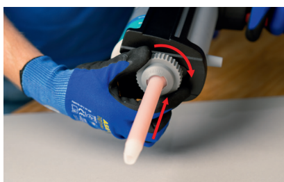
Statische menger met de wartelmoer fixeren
