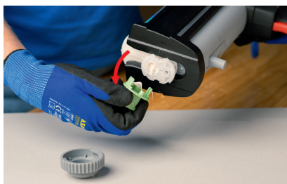
Wartelmoer afschroeven en stop verwijderen
