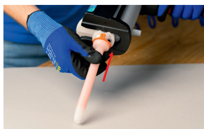
Materiaal afvegen en statische menger opzetten
