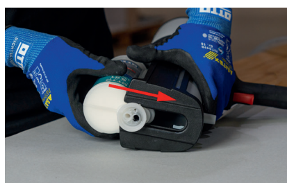
Inleggen van de side-by-side koker in het pistool
